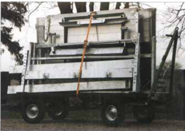
Der Spezial-Transportwagen hat einen Systemaufbau zur Verladung aller Containerteile mit sämtlichem Zubehör.
